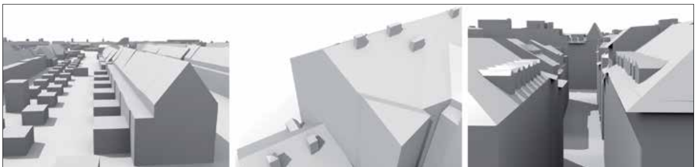
Figuur 3 - Dakvormen in LoD2, gemodelleerd op verschillende detailniveaus: gegeneraliseerd zonder detail (links); met details als dakvormen en grote schoorstenen (midden); dakvormen met overstek (rechts). De huidige CityGML-standaard maakt dit onderscheid niet.
